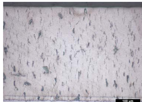
Bild 3b: Querschliff einer hartverchromten Schicht mit (gewolltem) Mikrorissnetzwerk
